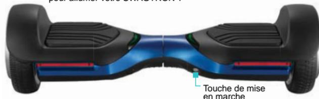
**ÉTAPE 2:** Appuyez sur une **PÉDALE** pour déclencher l'interrupteur au pied. Le système entrera en mode d'autoéquilibrage avec le clignotement du voyant lumineux du système.
